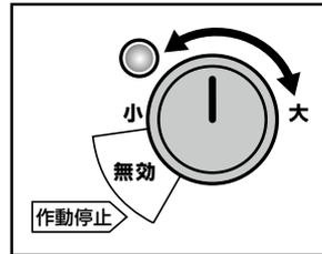
炎が大きく、炉内の天井に当たっているペレット供給量が多すぎますので、小さくしてください。
