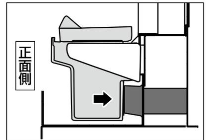
②給気穴に給気管が入るように、押し込んで
