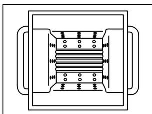
① 燃烧ポット[内]は底面のスリットが横方向に並ぶようにセットします。
