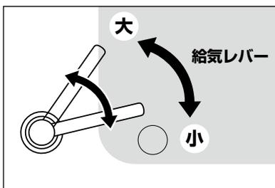
燃焼を安定させるため、給気量調節レバーがあります。
