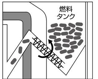
※燃料の大きさ・かたさによってはペレットが折れる音が発生します。
