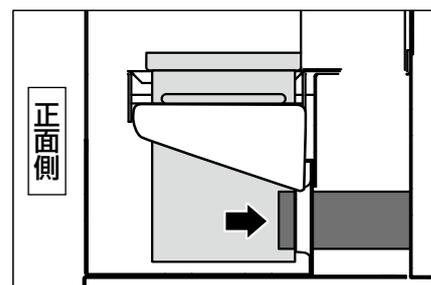
② 給気穴に給気管が入るように、押し込んでください。
