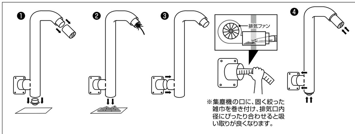
**① 排気トップとT字管ふたを外します。**※灰・ススの飛散を防ぐため、下に新聞紙等を敷きます。
